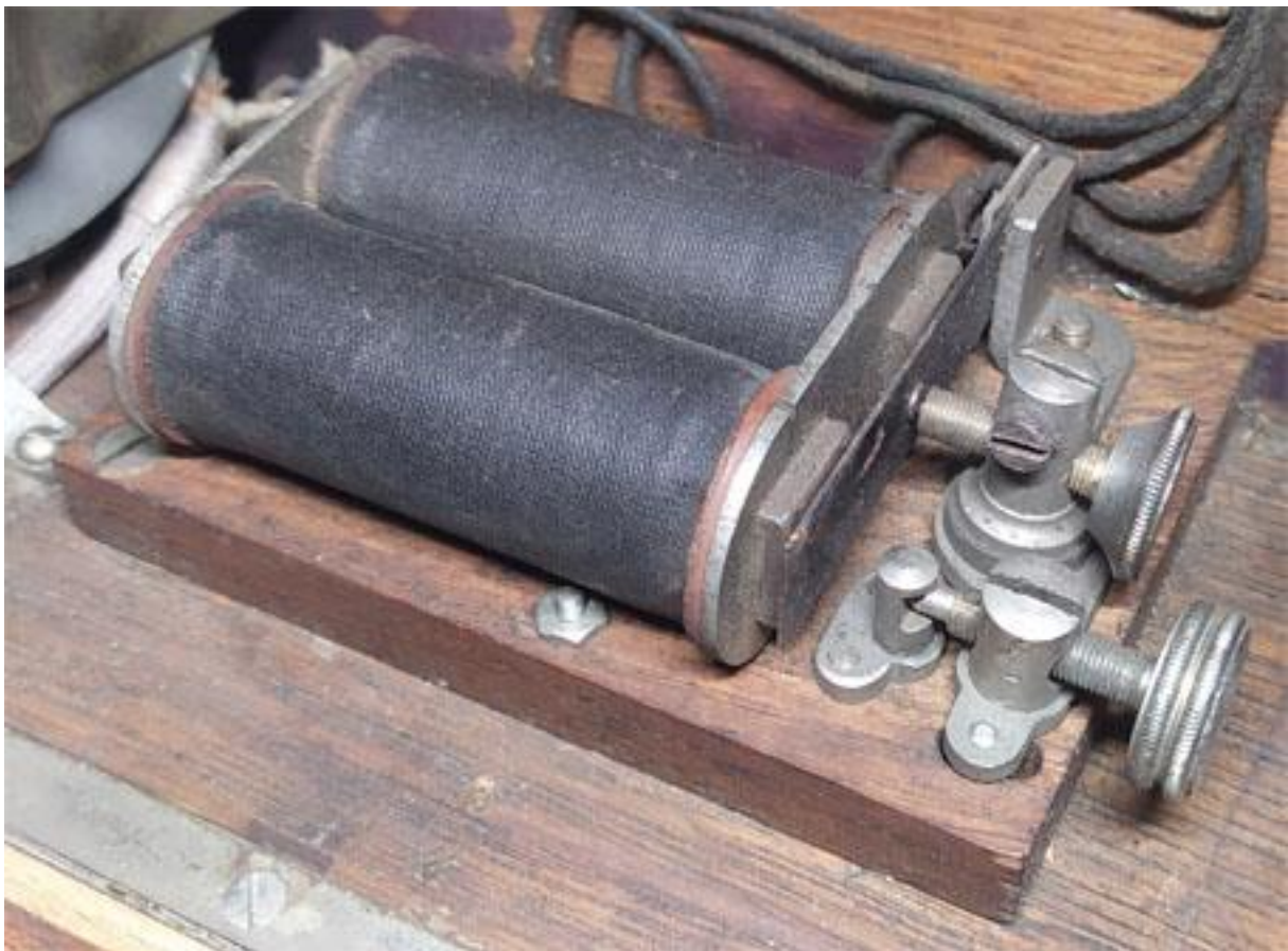
4. kép ▪ a 7 M. készülék rezgője
