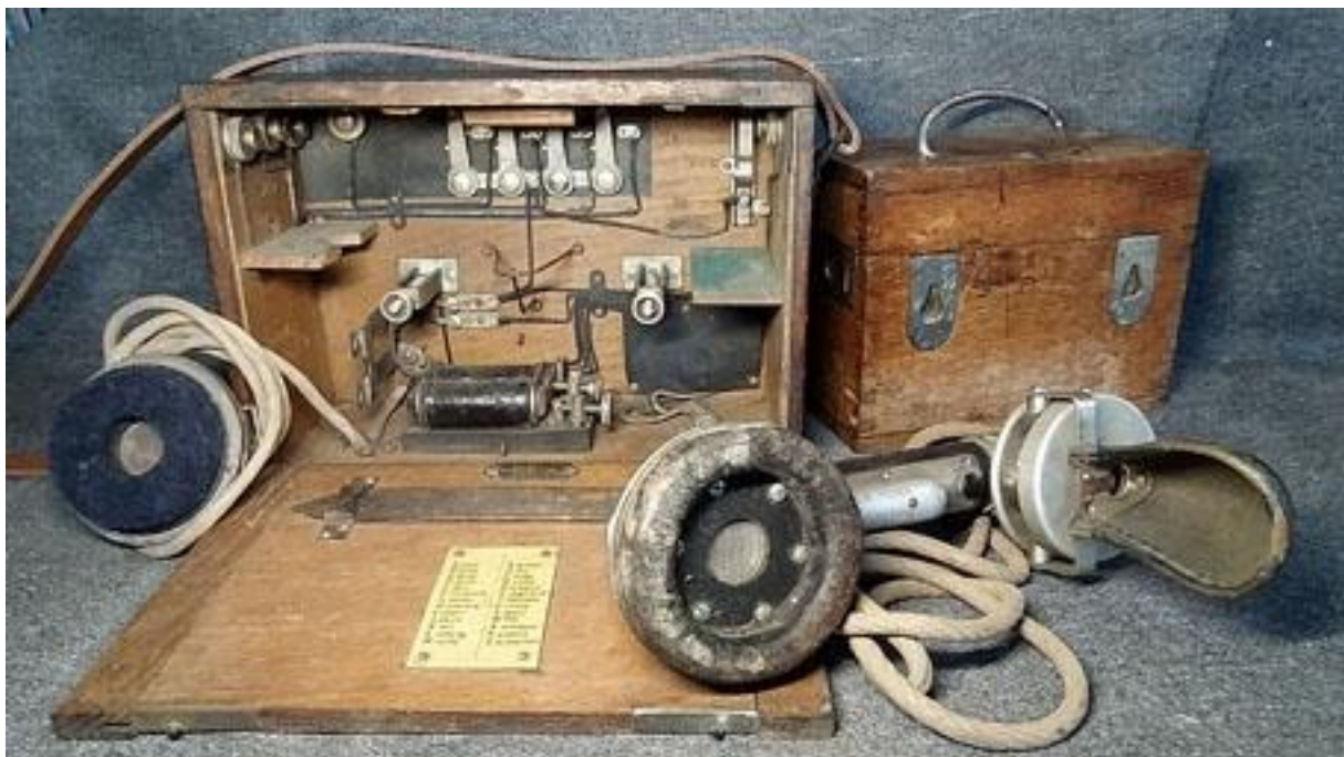
7. kép ■ a hadsereg alapkészüléke, a 7 M. beszélőszekrény (korai bécsi Kapsch und Söhne, a jobbán teleptartó dobozzal)
