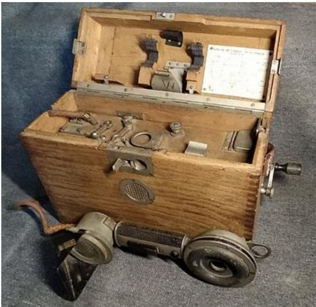
9. kép ▪ 10/16 M. induktoros és fónikus hívású távbeszélő készülék (bécsi S&H)
