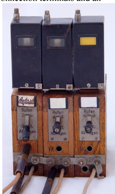
Figure 103: Small exchange using Vermittlungskästchen
