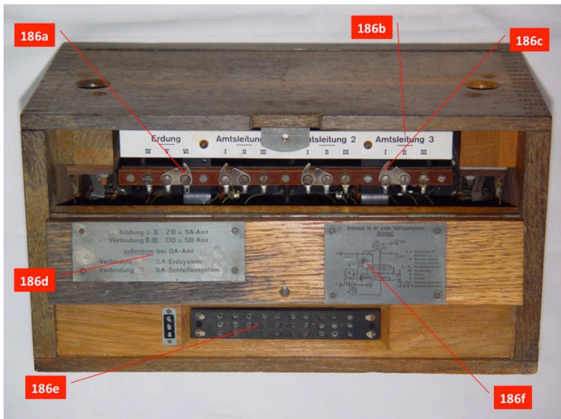
Figure 186: Amtszusatz rear view
