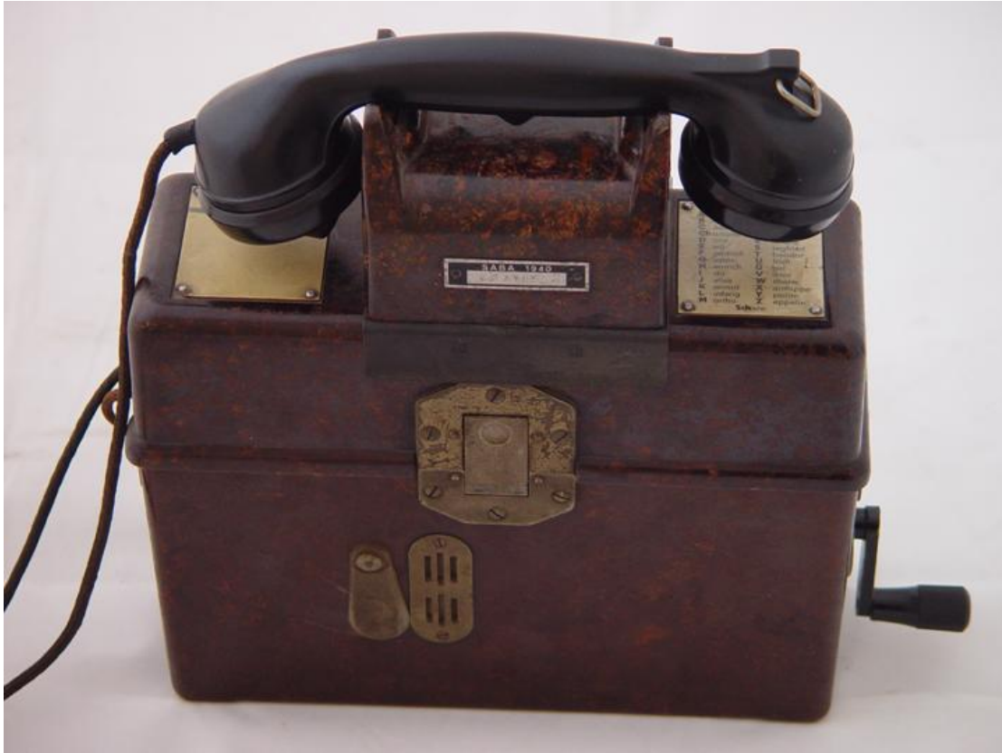
Figure 16: FF 33 with SB Zusatz
