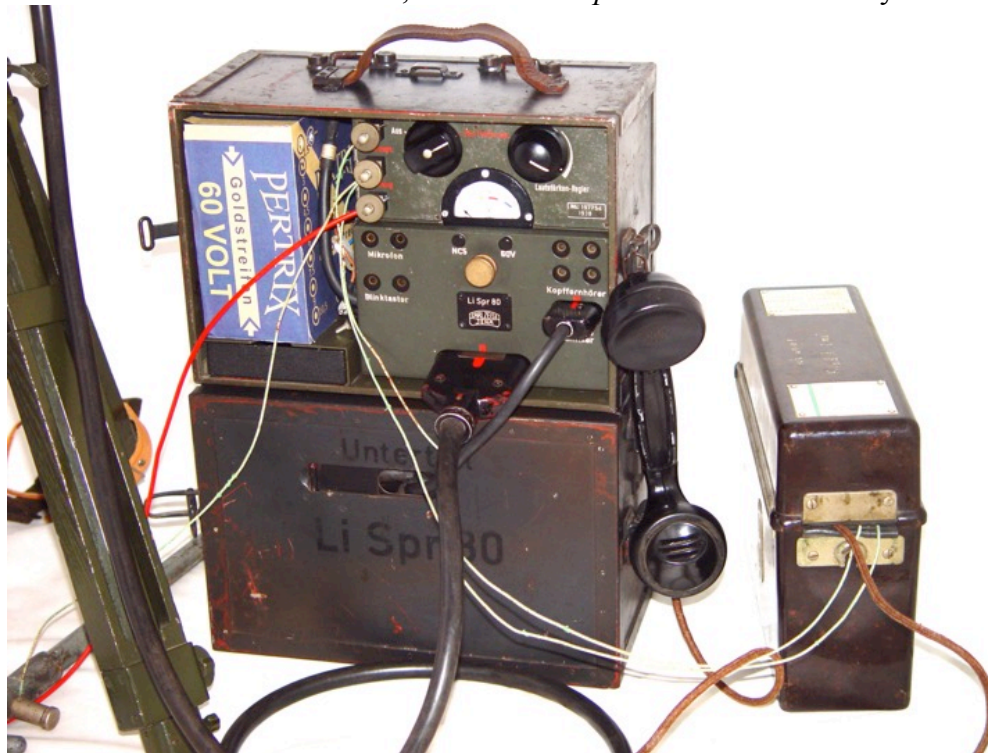
Figure 293: Lichtsprechgerät 80 connected to telephone line
