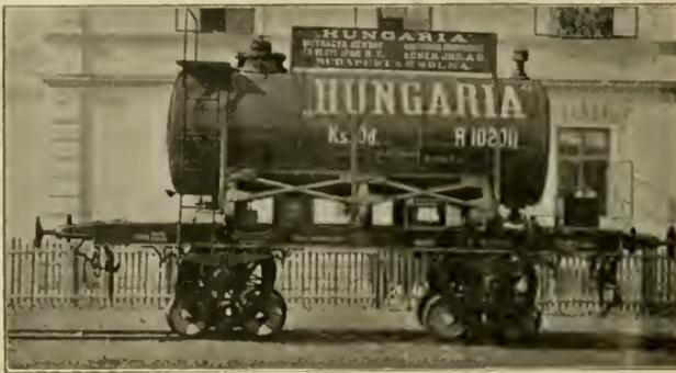
Abb 181. Ueberstellung normalspuriger Wagen auf Langbein'schen Rollschemeln.
