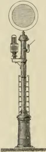
Abb. 30. Rommel's elektrisches Distanzsignal.
