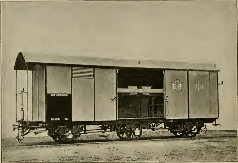
Abb. 178. Gedeckter Güterwagen mit 10 t Tragfähigkeit.
